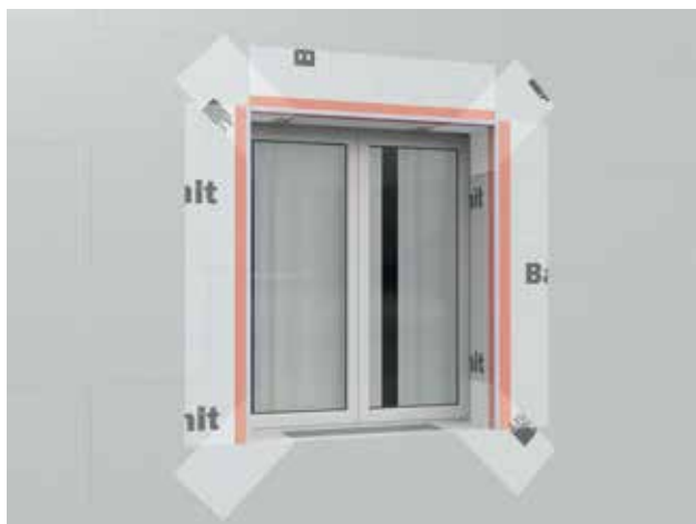
6.3.1 Applicazione DiagonalArmierung e SturzeckWinkel
