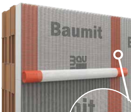
6.3.3 Applicazione della rete di armatura e dettaglio della sovrapposizione dei fogli di rete contigui (almeno 10 cm)
