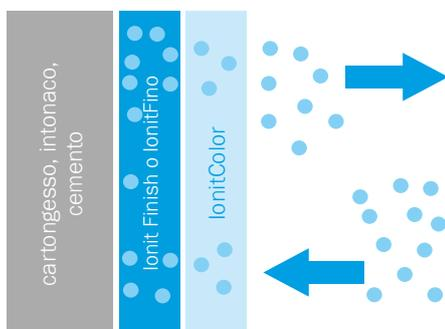
IonitFino e IonitFinish regolano l'umidità dell'aria all'interno. Assorbono il vapore acqueo quando l'umidità è elevata e lo rilasciano quando l'aria diventa secca.
