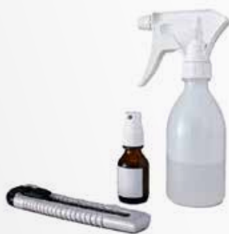
Soluzione fenolftaleina 1%, Cutter e Acqua demineralizzata
