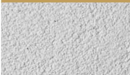
La formulazione unica garantisce un'elevatissima efficienza nel campo del consumo e della resa, a seconda della conformazione della superficie e della granulometria. Strutture graffiate con una granulometria massima di 2,0 mm presentano un consumo di 2,9 kg/m<sup>2</sup>, con granulometria massima di 1,5 mm presentano un consumo di 2,5 kg/m<sup>2</sup> e con una granulometria di 3,0 mm sono necessari 3,9 kg/m<sup>2</sup>.
