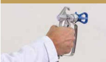
Grazie alla nuova formulazione, tutte le pitture per facciata Baumit sono adatte per l'applicazione airless! Per grandi superfici è possibile utilizzare pistole airless meccaniche. Questo permette di applicare la pittura rapidamente e in modo uniforme, risparmiando non solo tempo, ma anche denaro.
